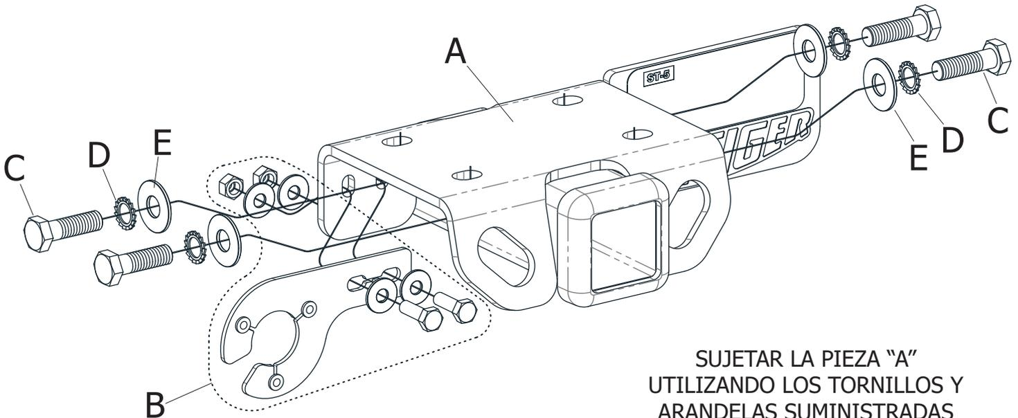
SUJETAR LA PIEZA "A" UTILIZANDO LOS TORNILLOS Y ARANDELAS SUMINISTRADAS (C, D Y E), MEDIANTE LOS AGUJEROS ROSCADOS UBICADOS EN LA CARA INFERIOR DE LA ESTRUCTURA DEL PARAGOLPES. LUEGO AGREGAR EL SOPORTE (B)
